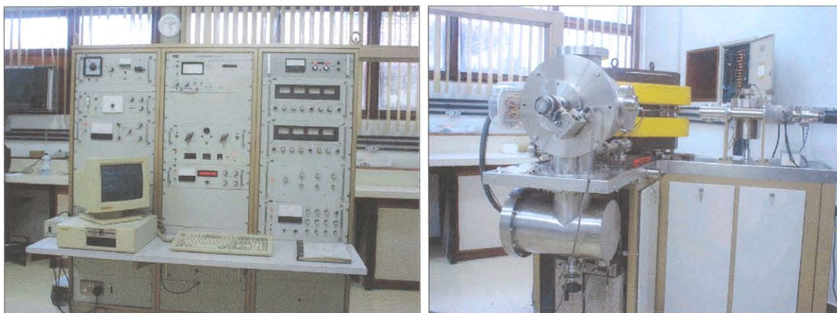
Figura 10 – Espectrômetro de massa VG 54E do Pará-Iso/UFGA, utilizado para análises de cristais de zircão pelo método Pb-Pb por evaporação de zircão em filamento simples, adaptado por Gaudette et al. (1993).
