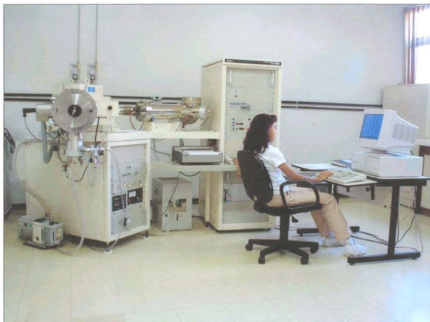
Figura 9 – Espectrômetro de massa Finnigan MAT262 do Pará-Iso/UFGA, utilizado para análises de cristais de zircão pelo método Pb-Pb por evaporação de zircão em duplo filamento, método de Kober (1986).
